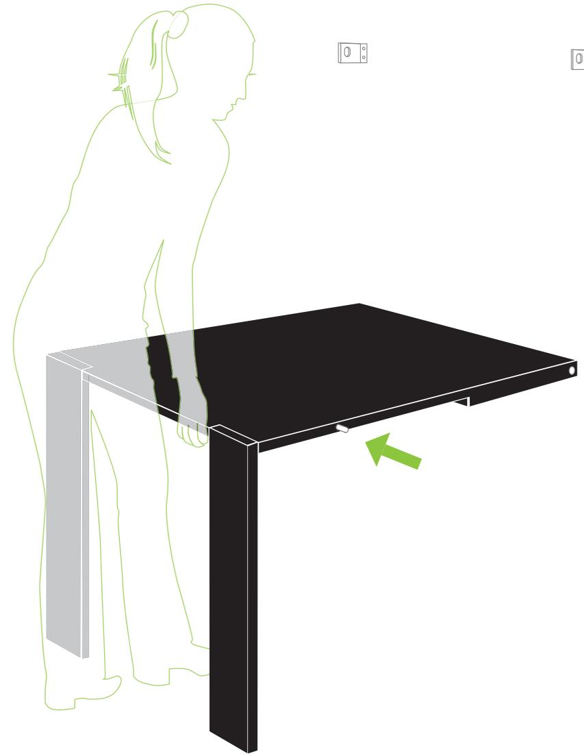
Push the **Upper Wall Mount Lock Bars** totally into the side of the table top before you fold the table up. Schieben Sie den **Oberen Riegel** der Wandbefestigung ganz in die Tischseite bevor Sie den Tisch nach oben klappen.
